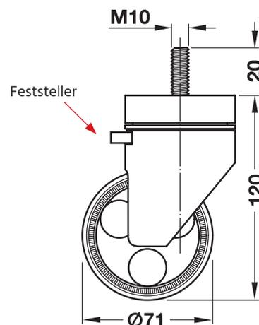
**HINWEIS:** Rolle kann an jedem Rondella-Bein mit  $\varnothing$  60 mm montiert werden. Zur Montage der Rolle je Rohr 1 Konus bestellen.
