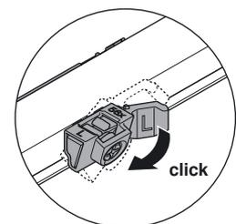
Werkzeuglose Montage von TIP-ON mittels Aufklippen.
