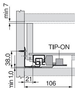
Zusätzlicher Platzbedarf für TIP-ON: 1 mm
