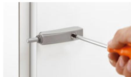
Gerade und Kreuzadapterplatte können über eine Gewindeschnecke verstellt (von + 4,5/- 1,5 mm) werden. Die Werkseinstellung des Türspalts beträgt 2 mm.
