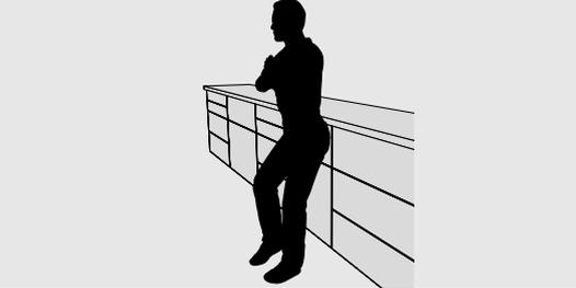
Die elektromechanische Öffnungsfunktion wird nur durch kurzes Drücken oder Ziehen ausgelöst. In sonstigen Fällen, wie beispielsweise einem Anlehnen, wird eine ungewollte Aktivierung bewusst ignoriert.
