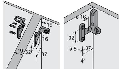
Mittelwandbefestigung mit Panhead  $\varnothing 4 \times 12$  mm
