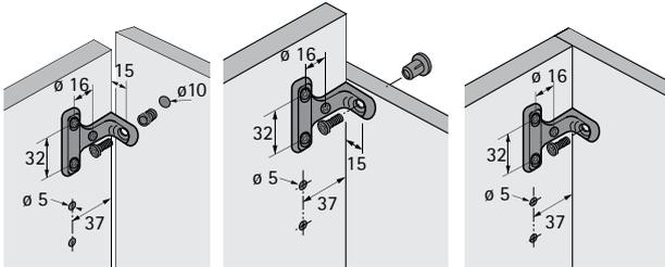
Stumpf aufliegende Rückwand (min. 16 mm)
