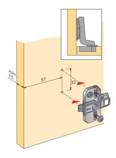
Ankörnposition Mittelwandanschlag vorliegend für Anschraub-Kreuzmontageplatte Hettich Top für Mittelwandanschläge mit vormontierten Spanplattenschrauben
