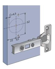
Ankörnposition Eckanschlag vorliegend für Hettich Montageplattensysteme 9000 (Intermat, Ecomat) und 2006 (Slide-on)
