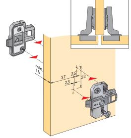
Ankörnposition Mittelwandanschlag einliegend für Anschraub-Kreuzmontageplatte Hettich Top für Mittelwandanschläge mit vormontierten Spanplattenschrauben
