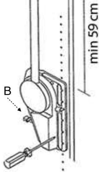
1) Entfernen Sie mit Hilfe eines Schlitzschraubenziehers die länglichen Abdeckkappen für den Zugriff auf die Anschraublöcher. Positionieren Sie die weißen Kunststoffdübel in die Bohrlöcher der Schrankseite, dort wo Sie den Kleiderlift platzieren möchten. Schrauben Sie den Kleiderlift an.
