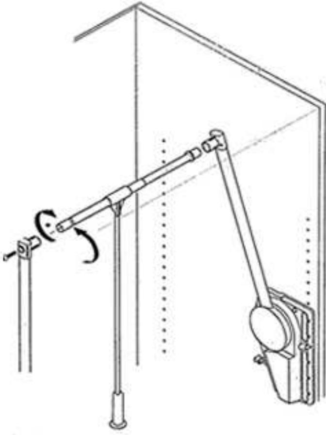
3) Ziehen Sie die Kleiderstange auf die passende Länge aus und stecken Sie sie in die Hülsen, schrauben Sie von Hand die passenden Schrauben von der Außenseite her ein. Ziehen Sie die Kleiderstange vorsichtig aus dem Schrankkorpus heraus und ziehen Sie die Schrauben mit einem Schlüssel an.
