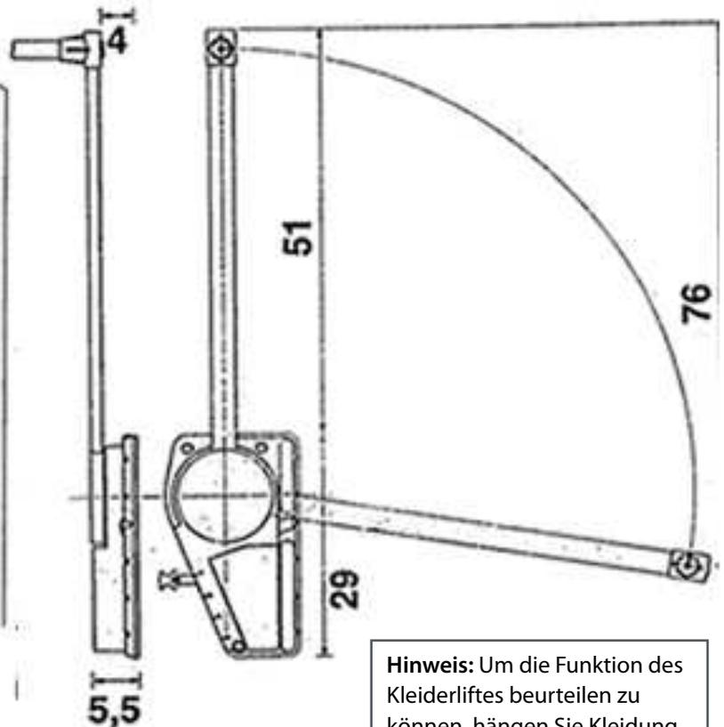
**Hinweis:** Um die Funktion des Kleiderliftes beurteilen zu können, hängen Sie Kleidung mit mindestens 10 Kilo Gewicht auf die Kleiderstange. Im leeren Zustand ist der Kleiderlift recht schwergängig.
