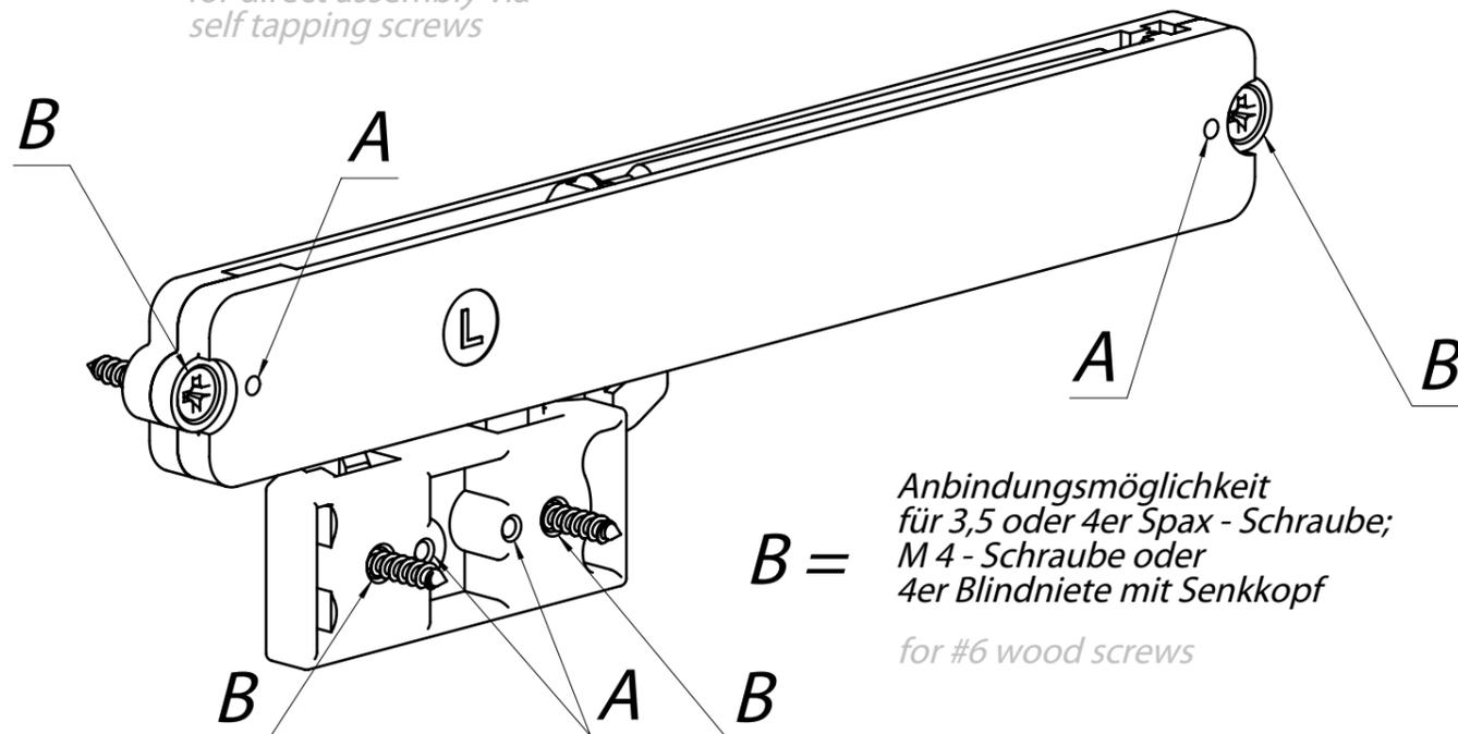
**B =** Anbindungsmöglichkeit für 3,5 oder 4er Spax - Schraube; M 4 - Schraube oder 4er Blindniete mit Senkkopf
