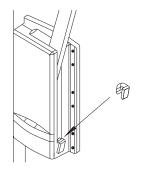
**HINWEIS:** Anschlagpuffer einsetzten! Der Anschlagpuffer **MUSS** nur eingesetzt weden, wenn der Lift beladen ist. Zu Ausstellungszwecken ist der Anschlagpuffer zu **ENTFERNEN**.
