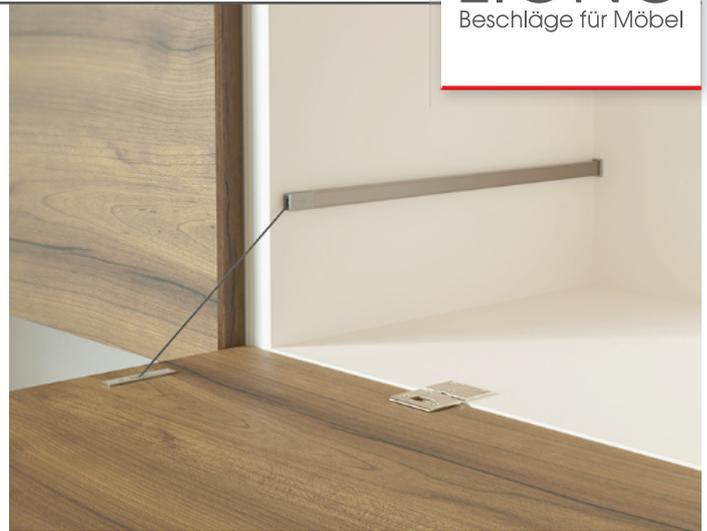
KIARO ist ein Öffnungssystem für Klappentüren mit verdecktem Mechanismus. Ein Kraftspeicher verfügt über vier verschiedene Stärkeinstellungen, welche die gängigsten Türgrößen und -gewichte abdecken. Da es sich um einen beidseitigen Mechanismus handelt, kann er sowohl rechts als auch links installiert werden. Ein hochwiderstandsfähiger technischer Draht gewährleistet eine erhebliche Tragfähigkeit bei minimaler Formgebung und elegantem Design.
