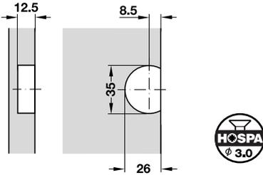
Bohrmaße im Boden und in der Klappe
