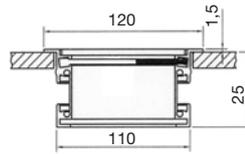
**Kabeldurchführung aus Aluminium, mit abgerundeten Ecken, mit Verriegelungsschieber, schwarzer Bürstendichtung**
