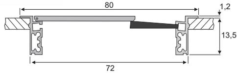
**Kabeldurchführung aus Aluminium, mit abgerundetem Klappdeckel, schwarzer Bürstendichtung und sanfter Schließfunktion**
