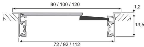
**Kabeldurchführung aus Aluminium, mit geradem Klappdeckel, schwarzer Bürstendichtung und sanfter Schließfunktion**
