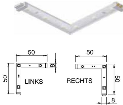
Der 90° Winkel (50 mm x 50 mm) für FlexyLED CR ermöglicht z.B. ein durchgängiges Ausleuchten der Unterkante einer Arbeitsplatte bzw. Möbelstücks.
