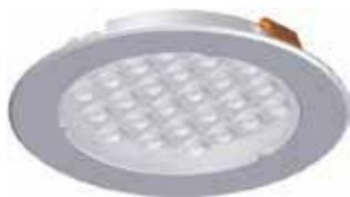
METRIS ist die ideale Einbauleuchte mit LED-Technik, die überall dort zum Einsatz kommen kann, wo sonst Halogenleuchten eingesetzt würden. Die Einbohrtiefe von nur 8 mm ist geringer als bei traditionellen Halogenleuchten. Die seitlichen Klammern halten die Leuchte werkzeuglos in der Bohrung. Das Anschlusskabel ist 2000 mm lang.
