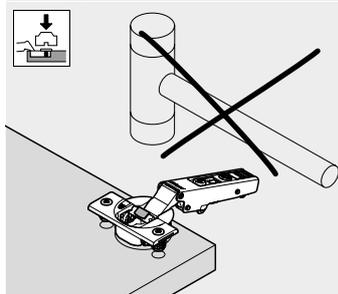
Den Scharniertopf nicht mit dem Hammer in die Bohrung einschlagen
