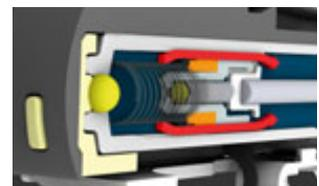
**Hohe Schließgeschwindigkeit:** Das Bremsselement dehnt sich aus und das Medium kann sich nur langsam durch die verengten Strömungskanäle bewegen. Das Ergebnis ist eine stärkere Wirkung von BLUMOTION.
