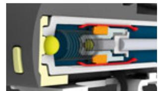
**Zu hohe Schließgeschwindigkeit:** Die Überlastsicherung tritt in Kraft. Der übermäßige Druck wird durch einen zusätzlichen Strömungskanal abgebaut und BLUMOTION sowie die Scharniere werden vor Beschädigungen geschützt.
