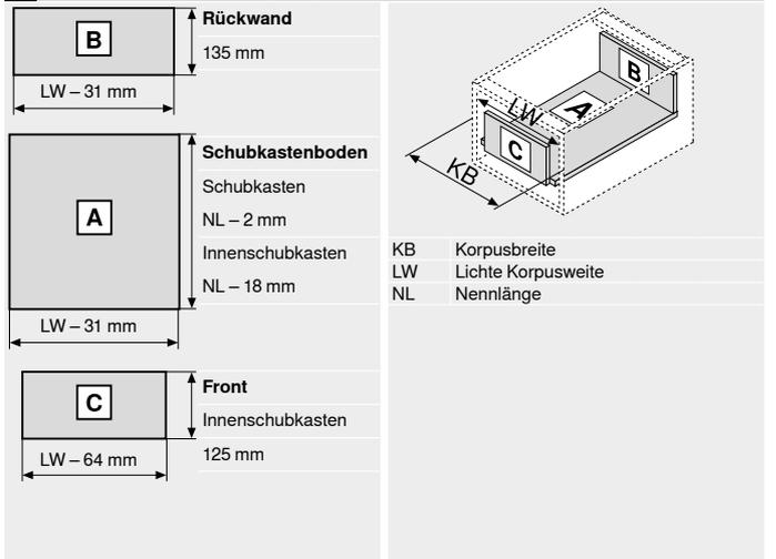
**Schubkastenboden bei Steckversion**
