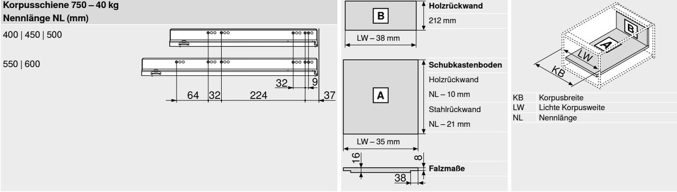
Korpuschiene 753 – 70 kg Einbohrmaße – Schubkastenboden
