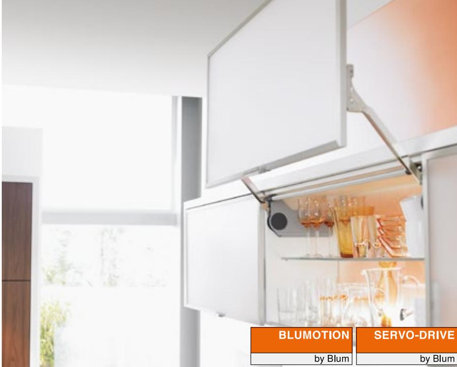
Mit AVENTOS HL wird die einteilige Front parallel zur Korpusfront nach oben bewegt. Dieses Klappensystem ist ideal für Anwendungen im Hoch- oder Oberschrank mit darüberliegenden Fronten oder im Hochschrankverbau sowie im Nischenschrank, um z.B. elektrische Geräte zu verdecken.
