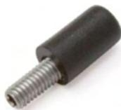
**1** Das Türanschlag-Set besteht aus einer Kunststoffkappe und einem M4 x 16 mm-Gewindestift, der an der Position **F1** im Profil angebracht wird. Hierfür wird zunächst eine Kernbohrung von 3,3 mm ins Profil gesetzt, in die ein M4-Gewinde geschnitten wird. Die Vorbereitung der Profile erfolgt idealerweise nach der Planung vor dem Zusammenbau der Vitrine. Der Gewindestift wird dann eingedreht und mit der zugehörigen Kunststoffhülse abgedeckt.
